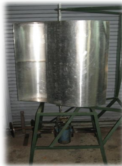
Gambar 6 Prototipe SKEA menggunakan rotor Savonius.
